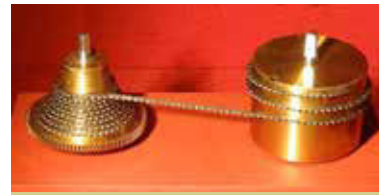
Fig. 8.- 1541 Model didàctic de fusée amb cadena (Museu Internacional de Rellotgeria, La Chaux-de-Fonds, Foto E. Farré)
