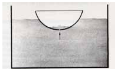
Fig. 11.- Principi de funcionament d'una clepsidra d'enfonsament (Turner 1984, p. 9)
